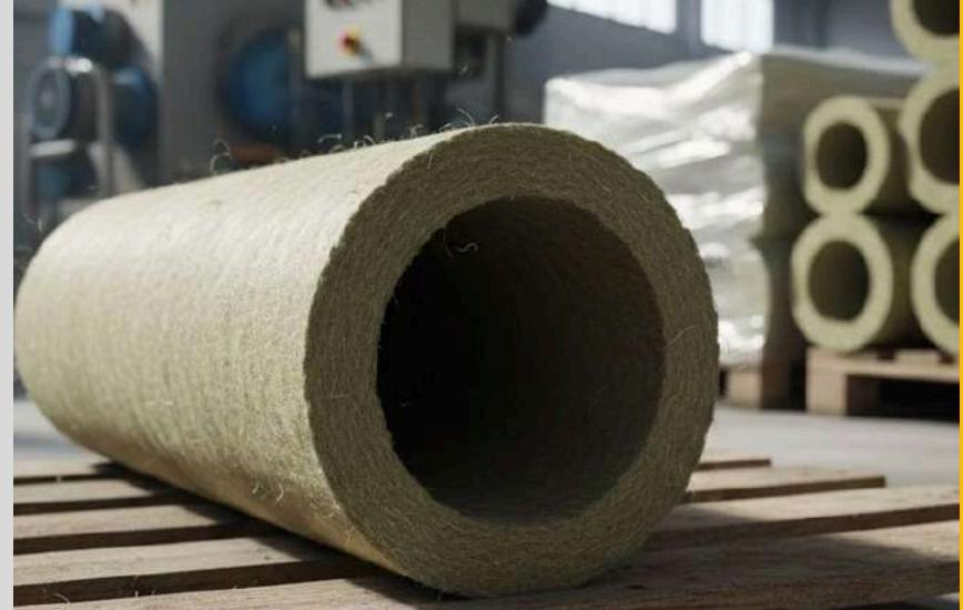
**Isolação Térmica:** os tubos de lã de rocha da Isopur em função dos baixos coeficientes de condutividade térmica, contribuem para redução dos custos de operação e economia de energia, uma vez que seguram a temperatura no ambiente interno. Suportam temperaturas até 750°C sem deterioração. Suportam picos de temperaturas superiores a 1000°C, com pouca ou quase nenhuma modificação em sua estrutura física.
