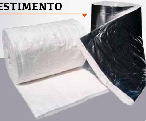
A manta de fibra cerâmica sem revestimento para isolamento térmico é produzida por um processo de entrelaçamento e agulhamento de forma contínua o que confere ao produto final uma ótima resistência mecânica além de ser leve e flexível também resiste à erosão. Por ser fabricada neste sistema, as mantas de fibra cerâmica dispensam a adição de ligantes. A manta de fibra cerâmica possui várias características como um isolante térmico de alta performance!
