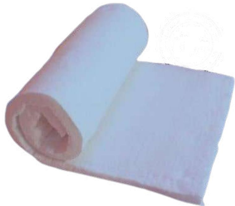
A manta de fibra cerâmica sem revestimento para portas corta fogo é produzida por um processo de entrelaçamento e aguilhoamento de forma continua o que confere ao produto final uma ótima resistência mecânica além de ser leve e flexível também resiste à erosão. Por ser fabricada neste sistema, as mantas de fibra cerâmica dispensam a adição de ligantes.
